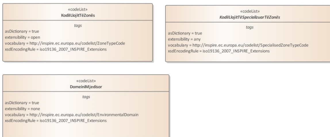
Figura 8 – Diagrama e klasës UML: Paraqitja e kodlistave të përfshira në skemën e aplikimit të zonave të menaxhimit, kufizimit ose rregullimit
