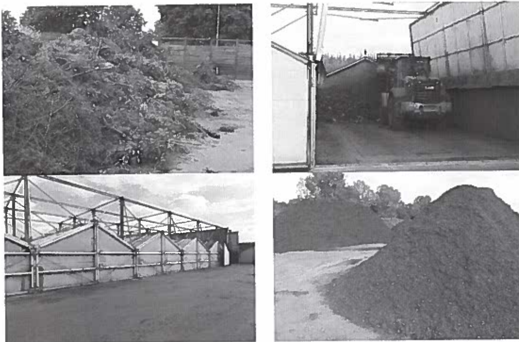
Figura 22 Shembull i një impianti kompostimi me ajrosje artificiale: materiali i sjellë, mbushja e kontenierëve me ajrosje, kompostimi në kontenierë, komposti i situar 51
