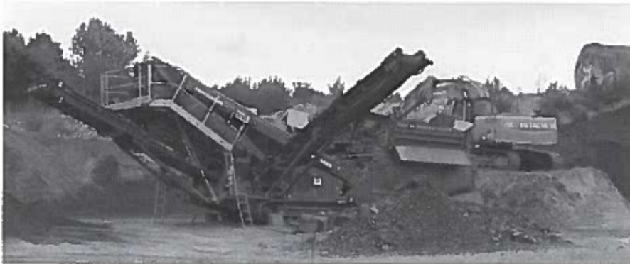
Figura 23 Shembull i një impianti të lëvizshëm për trajtimin e MNP 22
