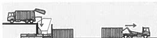
Figura 15 Parimet e ngarkimit të drejtpërdrejtë me dhe pa ngjeshje në stacionet e transferimit 42
