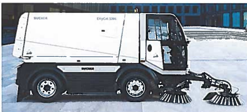
Figura 22 Diagramë bazë e një makine për fshirje me vakum me kapacitet mbajtës 5 m 3 4
