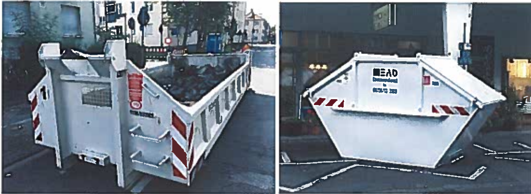
Figura 62 Majtas: kontenier i transportueshëm (roll-off), djathtas: kontenier i hapur nga sipër me kapak
