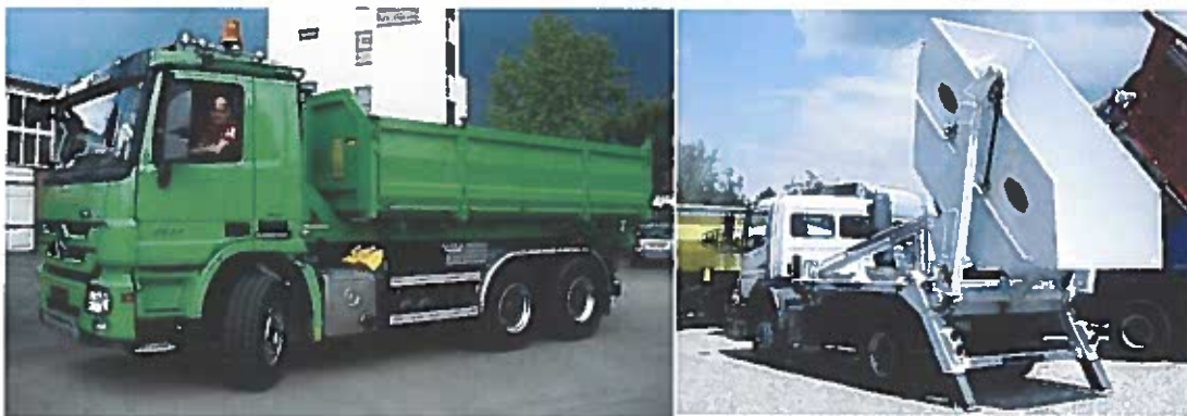
Figura 63 Majtas: Kamion vetëshkarkues me kontenier roll - off 51 , Djathtas: Kamion me vagonetë të kthyeshme që po lëviz kontenierin e kthyeshëm 52
