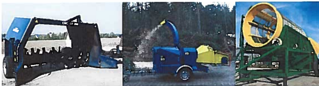
Figura 49 Pajisje kthimi me tërheqje e kompostit në kavaleta 31 (m.), makinë grirëse 32 (në mes), sitë cilindrike 33 (d.)
